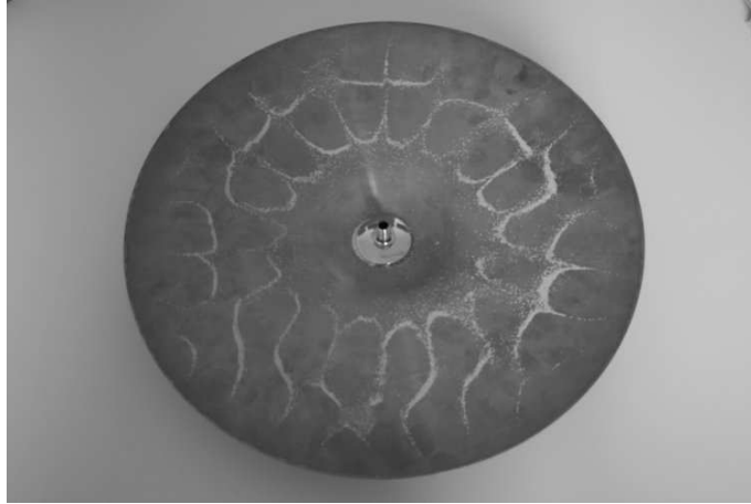
Abbildung 6.4: Chladnifigur bei etwa 1200\text{Hz} auf einem Cymbal
